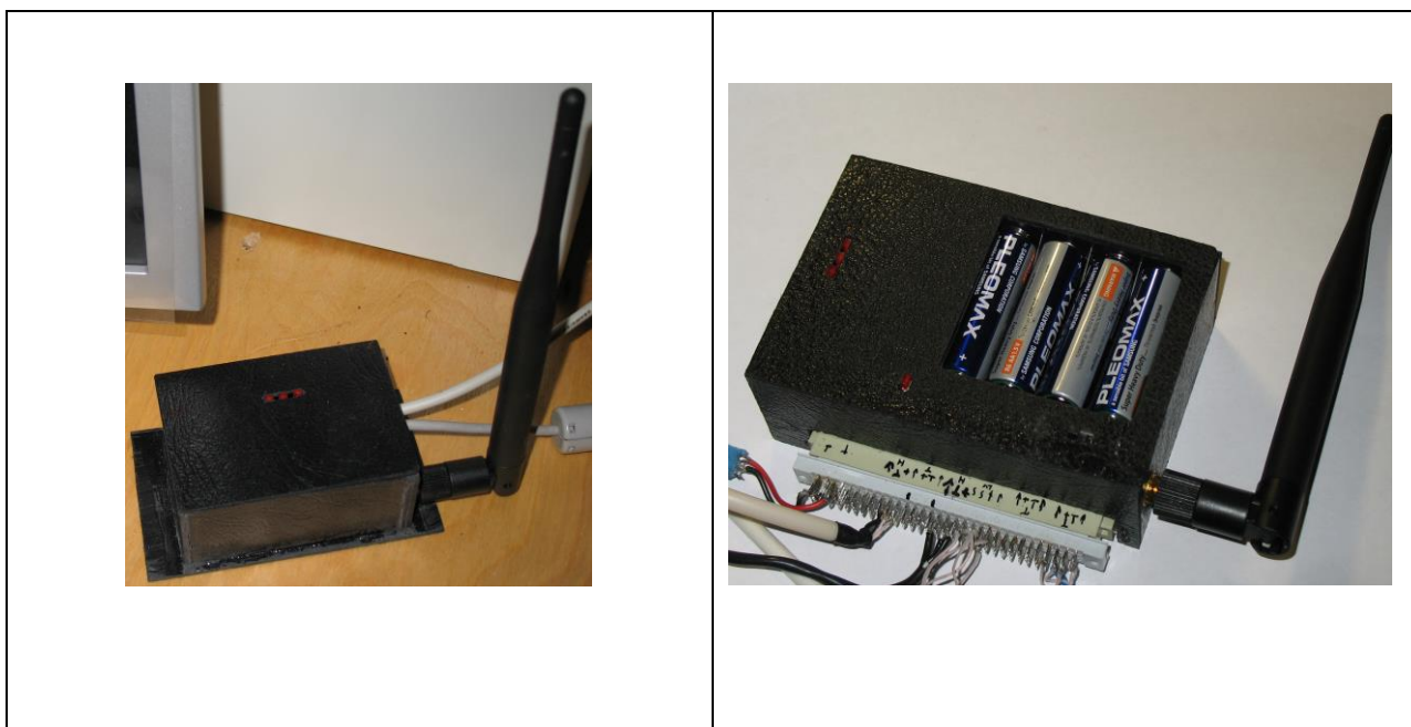
Рис. 5. Базисная станции (а) и сенсорный узел (б), разработанные ООО «НПП Геотек» ( www.geotek.ru )
